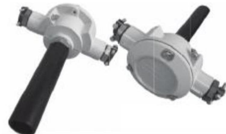
Коробка предназначена для обеспечения взрывозащищённости биметаллического максимально-дифференциального теплового датчика модели 12-Х27121-000 фирмы Kidde-Fenwal (США), сертифицированного ВНИИПО МЧС РФ в диапазоне температур от минус 60 до плюс 237°С для применения в РФ. Коробка в комплекте с датчиком модели 12-
